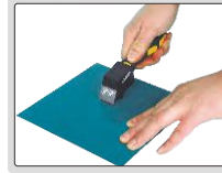
Adım 1: yüzeyde kesim yapılır
